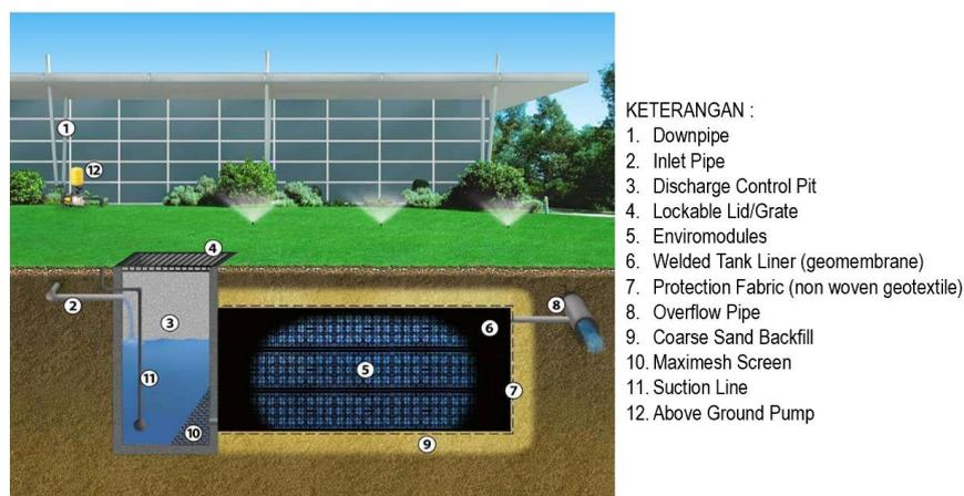
Gambar 3. Aplikasi Modular Tank untuk Ground Water Tank
