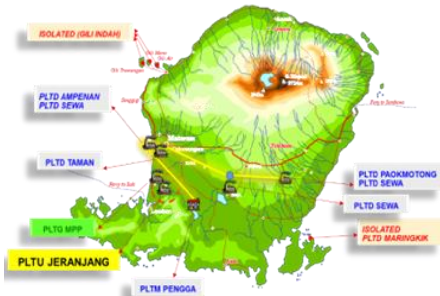
Gambar 3. Lokasi Genset PLTU 2 NTB – Jeranjang
